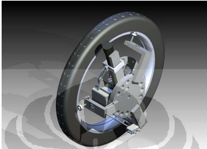
Gambar 4.9a. Posisi pemasangan alat pengukur terhadap roda depan (isometri)
