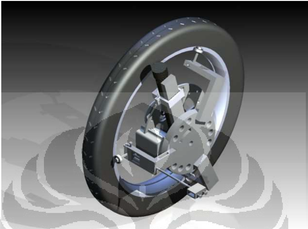
Gambar 5.2. Posisi pemasangan alat ukur terhadap roda depan
