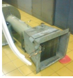
Gambar 3. 2 Bagian evaporator yang telah ditutup case
