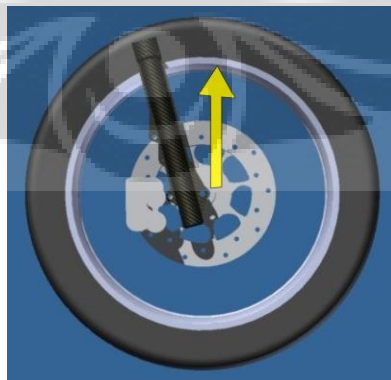
Gambar 3.13 Arah Gaya Pembebanan Vertikal pada Roda
