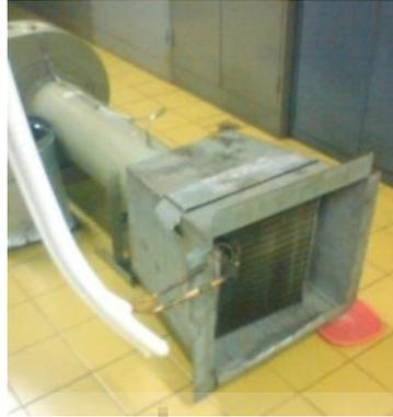
Gambar 3.2 evaporator pada suction apparatus
