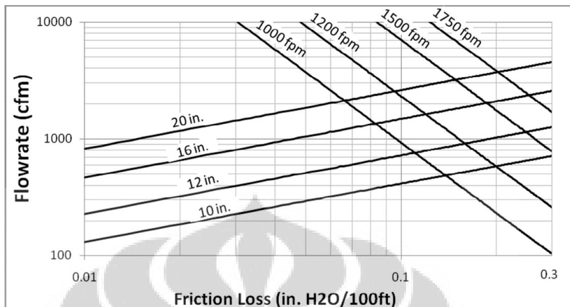
Gambar 4.3 *Friction chart* untuk *textile duct* taslan
