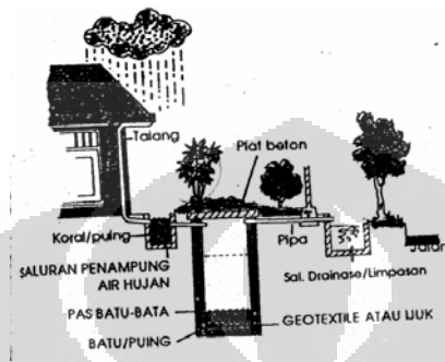
Gambar 2.8. Tipe rumah bertalang, sumur resapan dengan batu bata (sumber : standar sumur resapan buatan DKI 1993)
