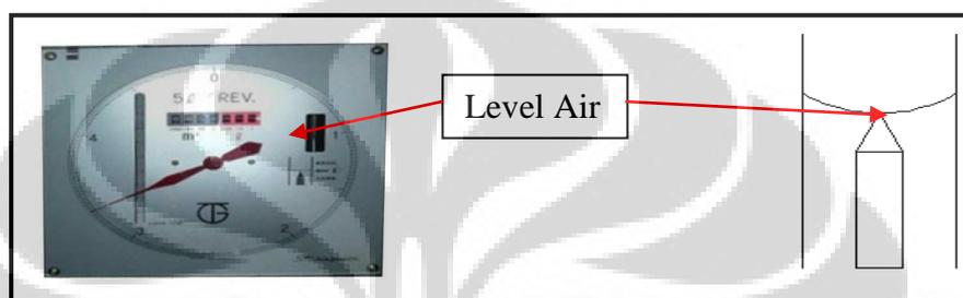
Gambar 3. 9. Level air pada *Wet Gas Meter* Shinagawa WE-2.5A
