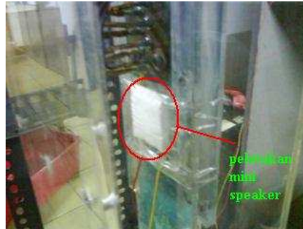
Gambar 3-18 Peletakan mini speaker di bawah step
