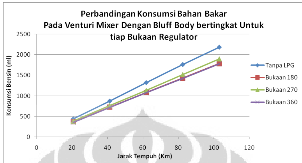
Gambar 5.7. Perbandingan Konsumsi Bahan Bakar Bensin Antara Tanpa LPG Dengan Penambahan LPG Pada Venturi Mixer Dengan Bluff Body Bertingkat Untuk Tiap Bukaan Katup Regulator
