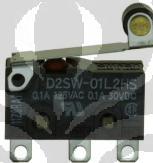
Gambar 4.5 Limit Switch yang Digunakan Robot Movemaster RV-M1
