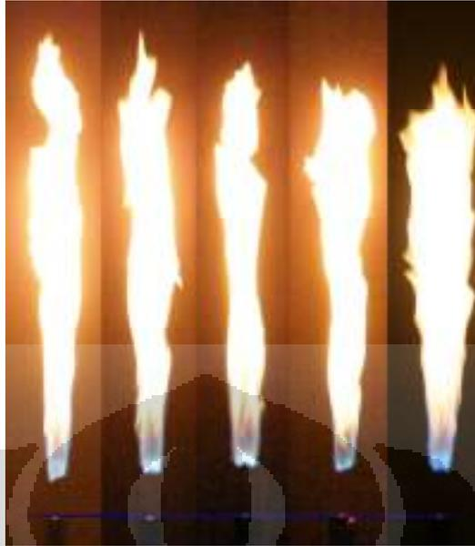
Gambar 4.8. Foto Nyala Api pada Laju Aliran Gas LPG yang Sama dengan Temperatur *un-burn* yang berbeda
