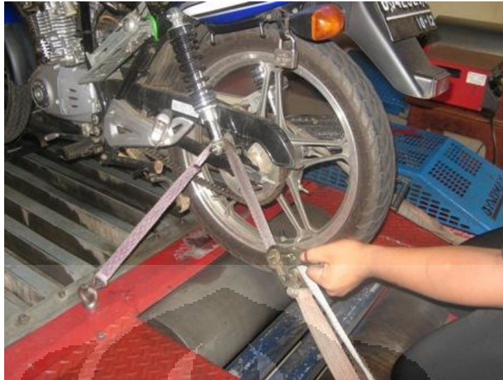
Gambar 3.24. Pengikatan motor dan penempatan diatas roller
