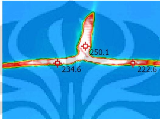
**Gambar 4.6** Citra termal dari sambungan kabel NYA 1.5 mm<sup>2</sup> yang dialiri arus 90 A [4].
