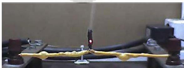
**Gambar 4.7** Gelembung udara pada pemanasan lokal permukaan dalam isolator kabel.
