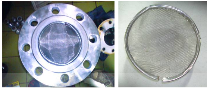
Gambar 3.7 Peletakan saringan dan saringan yang digunakan
