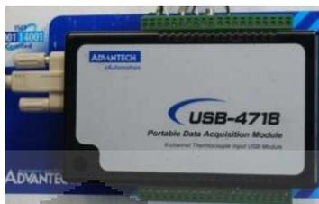
**Gambar 4.6** Data Akuisisi (Data Logger)
