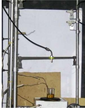
**Gambar 3.3** Nozel kabut air yang diikatkan pada pipa yang dapat di atur ketinggianya
