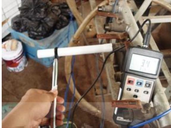
**Gambar 4.6** Penggunaan Hot Wire Anemometer
