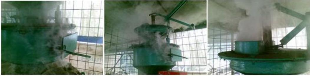
**Gambar 3.20** *Feeding Door* Baru dan Kebocoran yang Terjadi
