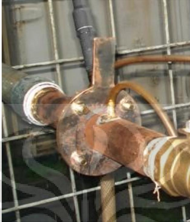
**Gambar 3.17** Orifice Plate di Laboratorium Gasifikasi
