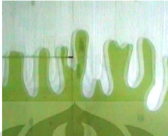
Gambar 2.2 Pola Fingering aliran viskos dari udara (putih) yang menembus minyak (Hijau) pada Hele-Shaw Cell
