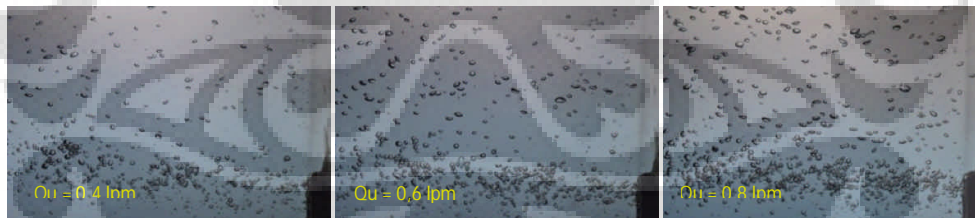
Gambar 4.33 Hasil Microbubble Spherical Ball microbubble generator dengan diameter bola 22mm pada debit air 35 lpm dan debit udara 4 lpm, 6 lpm, 8lpm.
