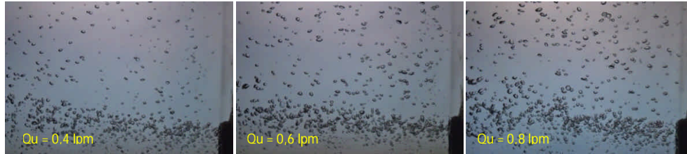
Gambar Hasil Microbubble Spherical Ball microbubble generator dengan diameter bola 24mm pada debit air 35 lpm dan debit udara 4 lpm, 6 lpm, 8lpm.
