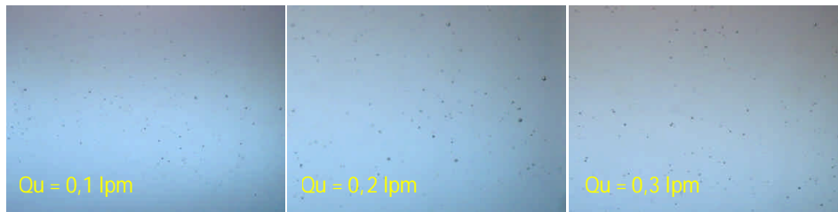
Gambar 4.24 Bubble hasil venturi dengan dv = 2 \alpha_d = 10^\circ Q_{air} = 8\text{lpm}
