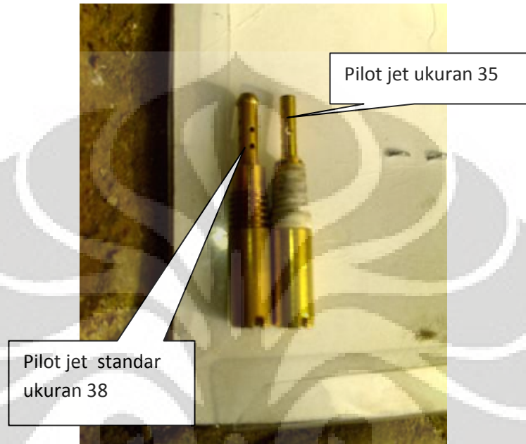
Gambar 3.10 Pilot Jet Ukuran Standar Dan Ukuran Yang Telah Diperkecil
