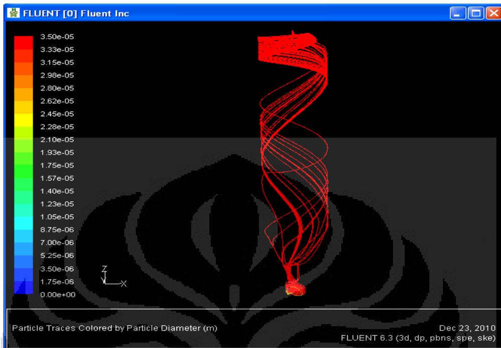
Perubahan diameter partikel pada flow udara 598,1 m<sup>3</sup>/jam, Temperatur 40<sup>o</sup>C
