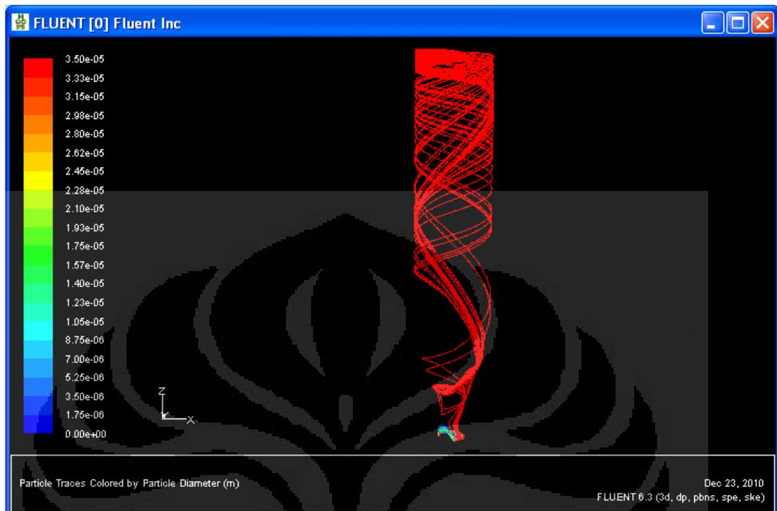
Perubahan diameter partikel pada flow udara 495,67 m<sup>3</sup>/jam, Temperatur 70<sup>0</sup>C
