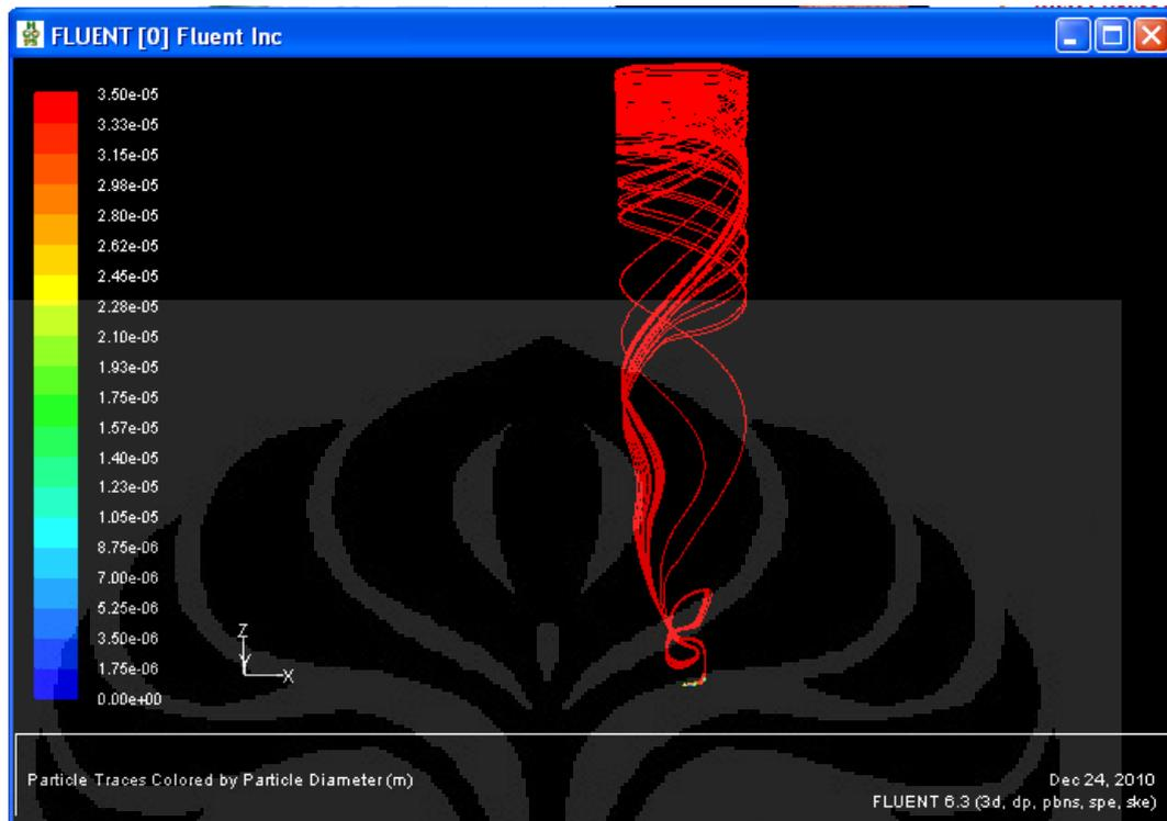
Perubahan diameter partikel pada flow udara 396,535 m<sup>3</sup>/jam, Temperatur 70<sup>0</sup>C
