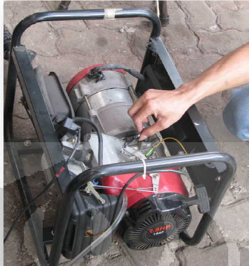
Gambar 3.9. Seting putaran mesin dengan membuka katup intake manifold di karburasi
