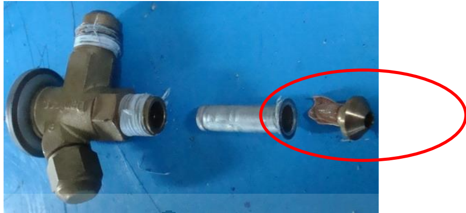
Gambar 2.12. Letak orifices pada TXV
