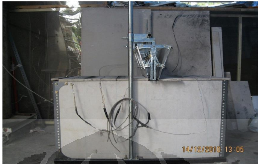
Gambar 3.8 Hasil perancangan dan pembuatanudukan nosel kabut air
