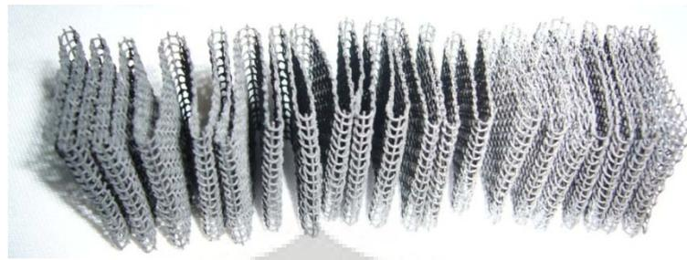
**Gambar 4. 4 Substrat setelah kalsinasi**
