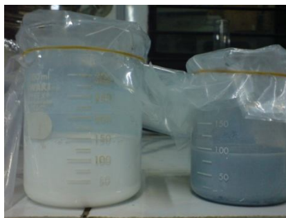
Gambar 4. 1 Larutan Sol TiO 2 saja (kiri) dan Sol TiO 2 -15%AC (kanan)
