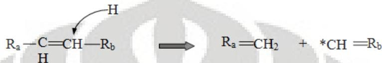
Gambar II-9. Reaksi perengkahan hidrokarbon (R<sub>1</sub>)
