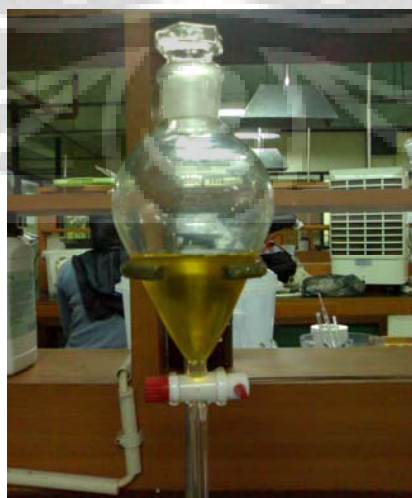
Gambar 4. 13 Hasil pemurnian metil ester dengan menggunakan air hangat
