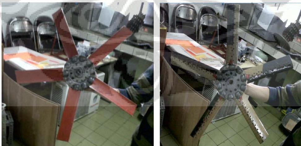
Gambar 3.5 lapisan ber-*dimple* pada sisi hisap blade
