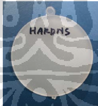
Gambar 3.16 Sampel Plague Bulat untuk Pengujian Impak Gardner dan Kekerasan
