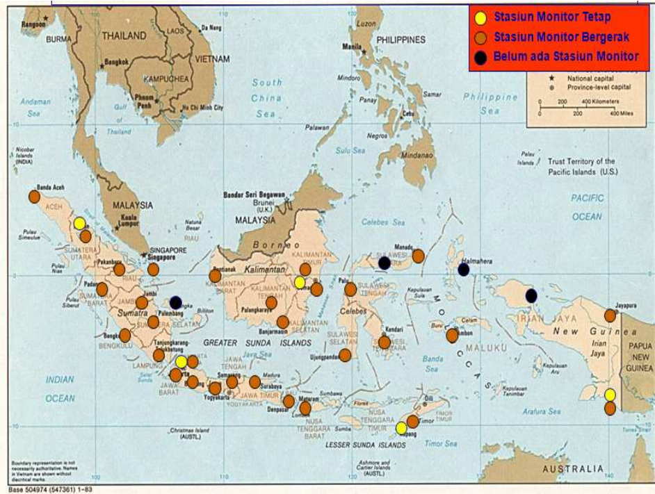
Gambar 2.2. Kondisi eksisting perangkat monitoring frekuensi di Indonesia
