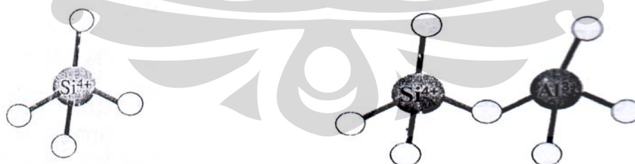
a. unit dasar Si dengan 4 O b. \text{Al}^{3+} menggantikan \text{Si}^{4+} , berkoordinasi tetrahedral dan oktahedral
