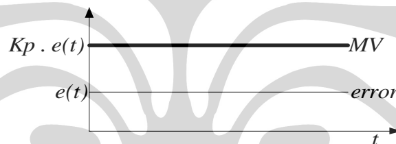
Gambar 2.7. Grafik Respon Aksi Kontrol Proporsional
