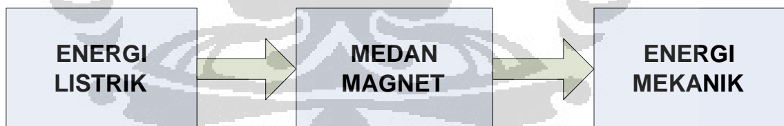
Gambar 2.2 Proses Konversi Pada Motor DC
