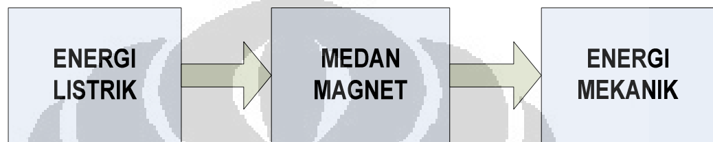
Gambar 2.5 Proses Konversi Energi Pada Motor DC
