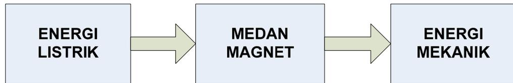
**Gambar 2.13: Proses Konversi Pada Motor DC**
