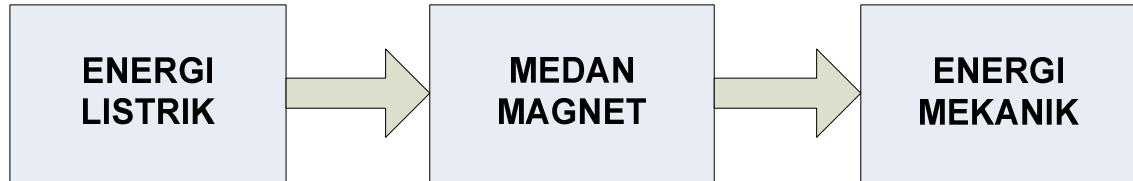
Gambar 2-3. Proses Konversi Energi Pada Motor DC
