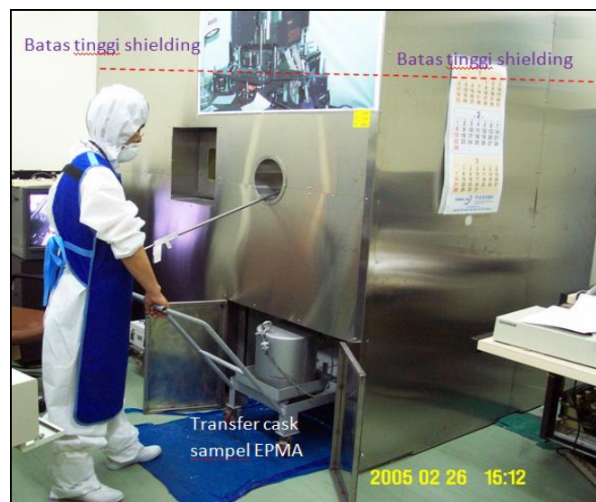
Gambar 6: Contoh kotak berperisai radiasi EPMA [7]
