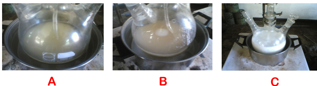
Gambar 2. Indikator reaksi transfer hidrogenasi minyak jarak kastor, (A) minyak jarak kastor sebelum reaksi-berwarna kuning, (B) awal penetesan hidrogen peroksida-berwarna jingga, (C) akhir penetesan hidrogen peroksida-berwarna putih.
