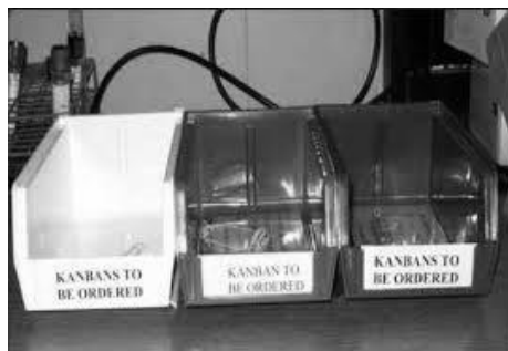
Gambar 7.17 Contoh kotak Kanban obat-obatan yang akan dipesan, jika kartu kanban terletak di keranjang, berarti pemesanan obat harus dilakukan.
