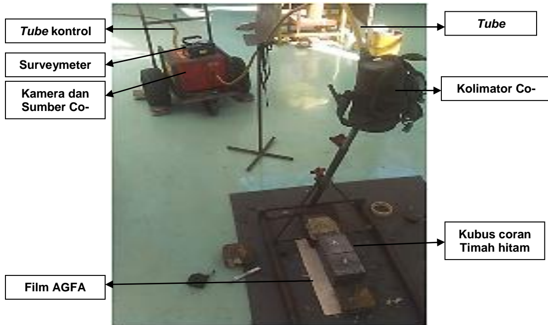
Gambar 4. Set up radiografi pada kubus coran Timah hitam 1 dan 2
