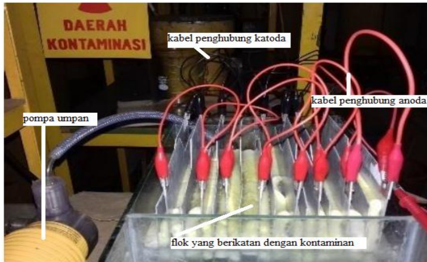
Gambar 4. Proses elektrokoagulasi yang menghasilkan endapan dalam permukaan reaktor
