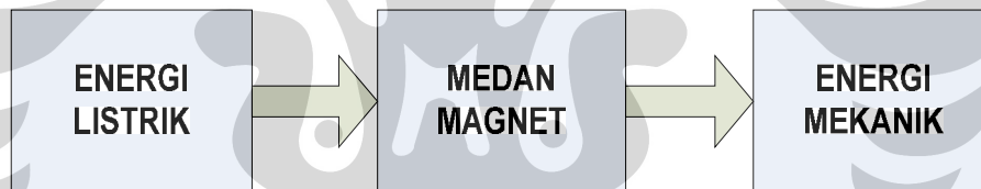
Gambar 2.6 Proses Konversi Pada Motor DC
