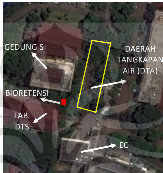
Gambar 4.11 Daerah Tangkapan Air Pilihan Dua
