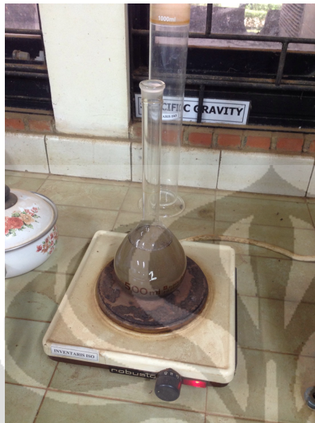
Pemanasan untuk Pengujian Specific Gravity
