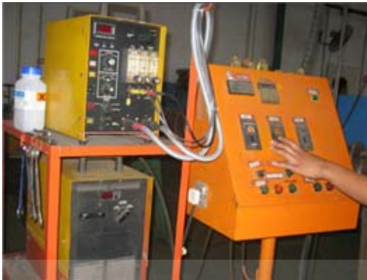
(a) Alat pengendalian laju bubuk dan perubahan arus listrik.
