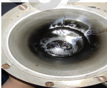
Gambar 4.4 Produk Samping dari Reaksi Perengkahan (Dokumentasi Penulis, 2022)
