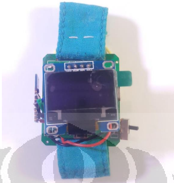
Gambar 4. 1 Desain prototipe gelang pulse oximeter berbasis mikrokontroler seeeduino
