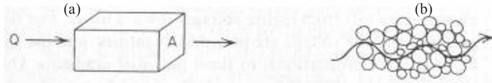
Gambar 2-2 Konsep makroskopik (a) dan mikroskopik (b) aliran air tanah
