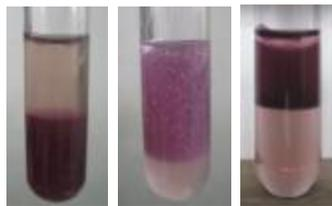
Gambar 4.69 Au-NP/alginat/dodekanatiol dalam emulsi minyak-air dengan berbagai variasi minyak. Minyak = kloroform, toluena, petroleum benzine, dari kiri ke kanan
