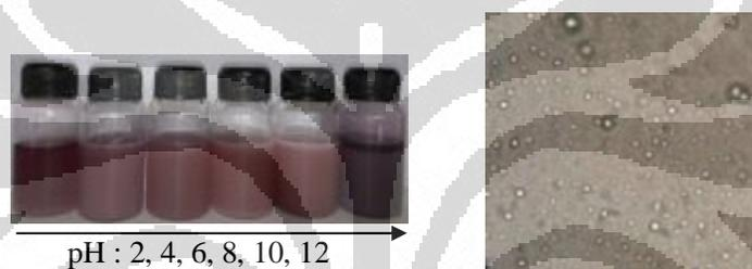
Gambar 4.87 Kiri : Sistem emulsi kloroform dalam air yang distabilkan oleh nanokomposit Au/alginat/MUA/dodekanatiol pada berbagai pH. Rasio Au/alginat : MUA : dodekanatiol = 6:2:2 dan konsentrasi MUA 0,001 g/25 mL. Kanan : Foto mikroskop optis untuk emulsi pada yang distabilkan oleh nanokomposit Au/alginat/MUA/dodekanatiol pada konsentrasi MUA = 0,001 g/25mL
