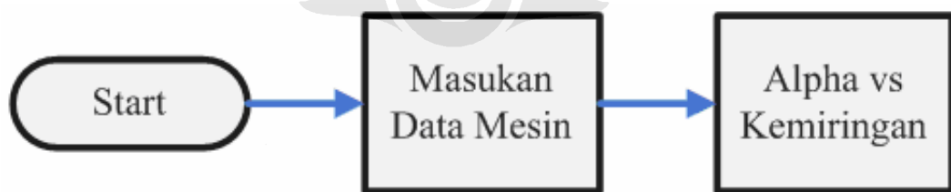
Gambar 3.5 Diagram alir logika memasukan data generator serempak
