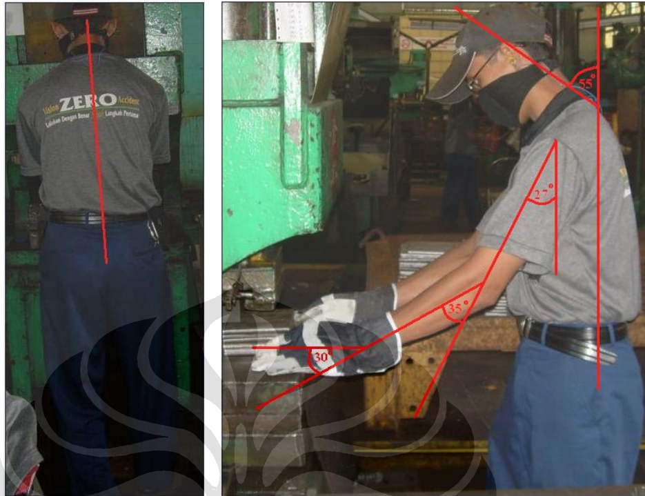
Gambar 6.5 Postur Janggal Pada Leher Yang Menekuk Ke Bawah Pada Proses Kerja Stamping Plate
