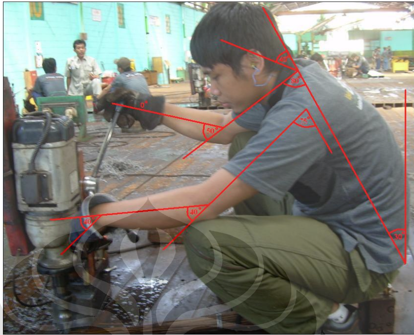
Gambar 6.15 Postur Janggal Pada Badan Yang Membungkuk Pada Proses Kerja Drilling Magnetic Drill Dalam Posisi Duduk ( Sitting )
