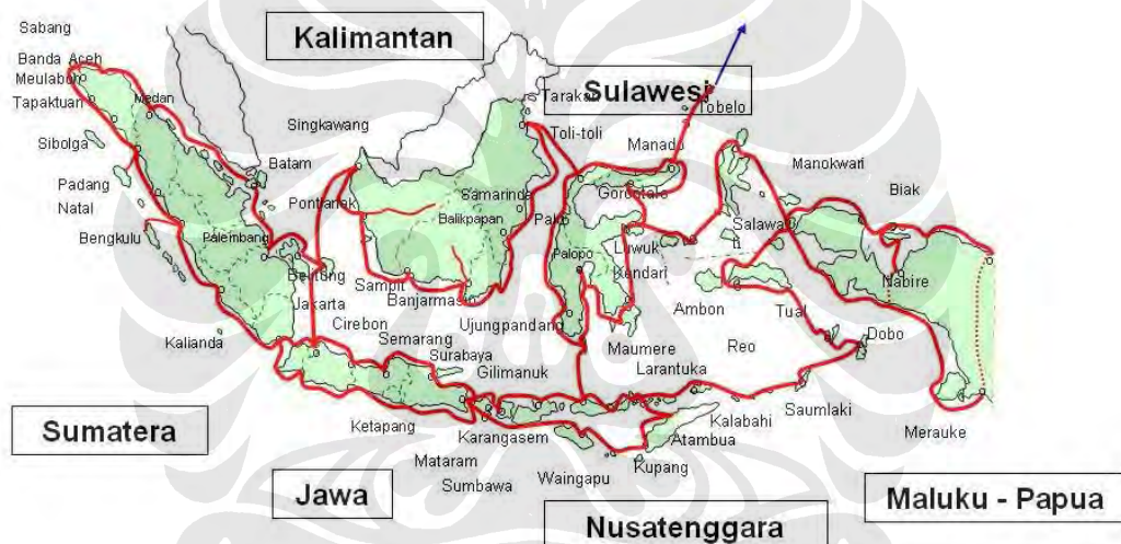
Gambar 2.1 : Skema Jaringan Cincin Palapa [1]
